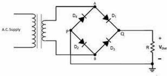
Figure 2 [5] : Universal Bridge Rectifier
