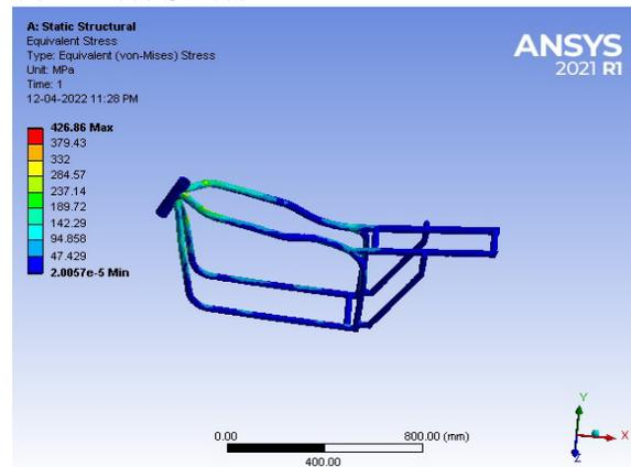
**Fig 7 : Von Mises Stress Analysis**
